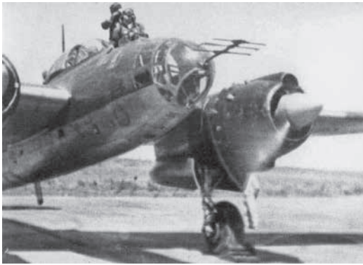
「銀河」の機首：電探（レーダー）用の八木アンテナ装備
