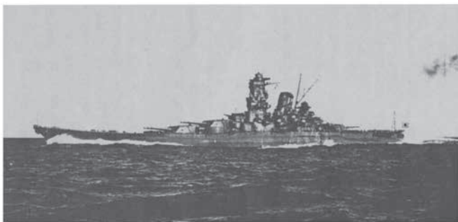
昭和16年10月30日、宮毛湾沖樫柱間で全公試運転中の大和(その3)——ワシントン海軍軍縮条約による海軍休日の際戦終了を迎えて、日本海軍が建造した戦艦大和型のネーム・シップである。史上最大の艦砲である45口径46センチ砲を9門搭載、回砲弾に対する十分な防護を備え、連力27ノットを発揮、基準排水量は64,000トンに達し、人間がつくりあげた最大、最強の戦艦であった。なお、この時の状態は69,304トン、151,700軸馬力、27.3ノットである。
