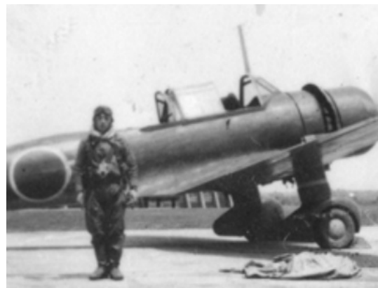
神州隊の機体。爆弾懸吊架が見える。胴体の窓から軍偵察機ベースの機体であることが分かる。
