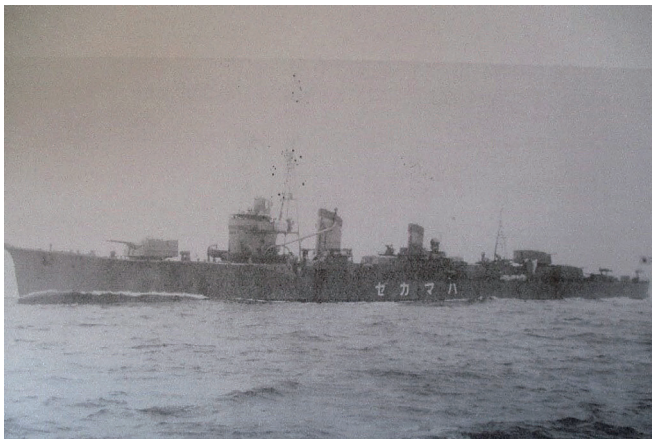
駆逐艦 浜風 (昭和16年ころのもの) 天一号作戦参加時は後方2番砲塔が撤去され3連装機銃に、艦橋前にも3連装機が増設されていた。
