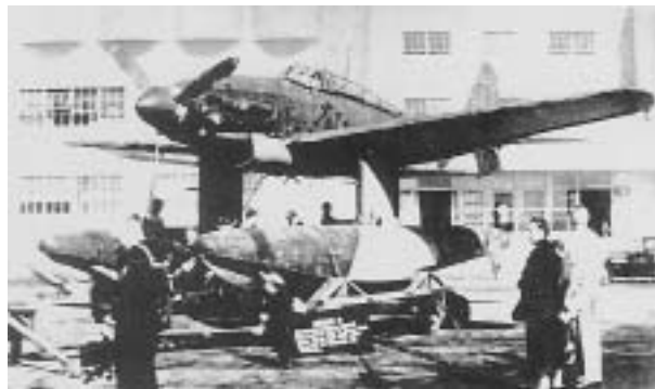
▲特殊爆撃機「晴嵐」 搭乗員2名、発動機単発1400馬力、最大時速高度4000米において254軒、航続距離610～830海里、武装13耗旋回機銃1、爆弾800kg 1。
