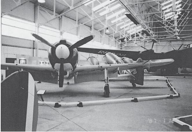
五式一型戦闘機 (キ100-1) ~川崎航空機製~ (1996年7月13日、英国コスフォードエアミュージアムにて、岸 由男氏撮影) ~全幅12.00m、全長8.82m、全備重量3.495Kg、発動機ハ-112-II、空冷二重星型14気筒、離昇出力1.500馬力、最大速度580km/h、巡航速度400km/h、航続距離1.400Km (日本航空機総集より)
